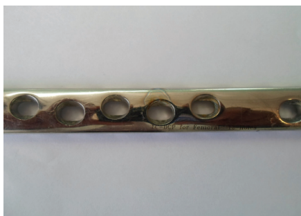
Рис. 7, 8. В местах соприкосновения различных по химическому составу элементов металлоконструкции образуются очаги электрохимической коррозии.
