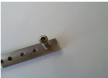
Рис. 9,10. Повреждение поверхностного защитного слоя металлоконструкции из-за грубых манипуляций хирурга при моделировании.
